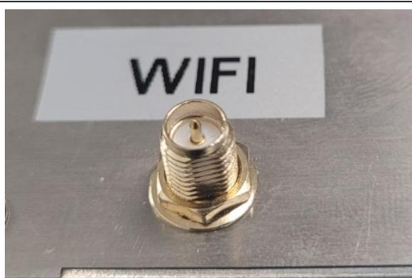
Figura 6: Connettore dell'antenna Wi-Fi
