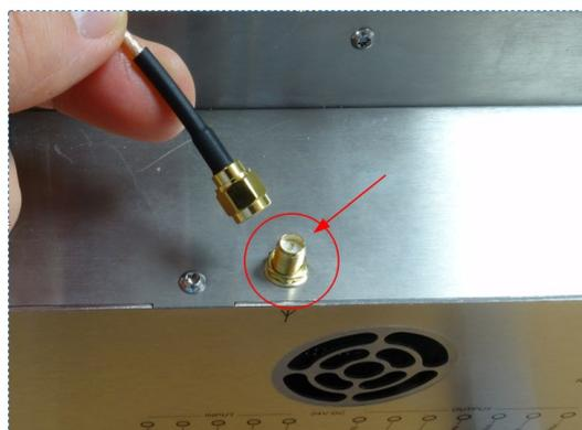
Figura 7: Posizione del connettore dell'antenna Wi-Fi
