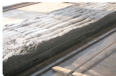
Ilustración 2: Un ejemplo de hormigón aligerado en colapso debido a una consistencia incorrecta
