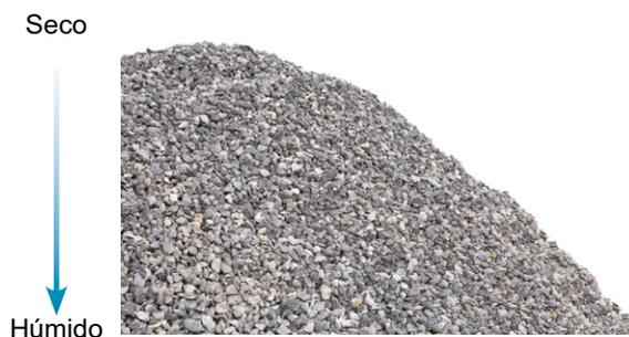
**Figura 1: Drenagem natural da humidade numa pilha de agregado**
