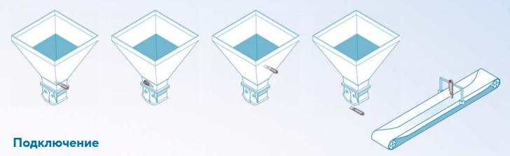
Цепочку, содержащую до 16 датчиков, можно подключить непосредственно к системе управления через канал последовательной связи RS485.
