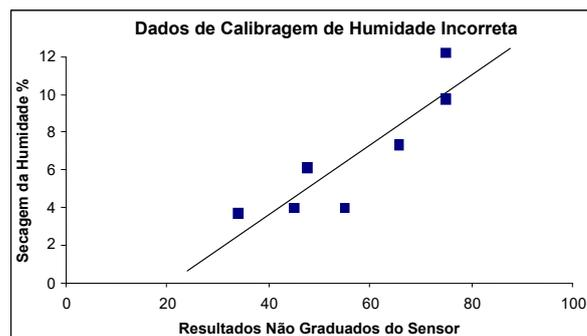
Imagem 19: Exemplos de Pontos de Calibragem de Material de Má Qualidade
