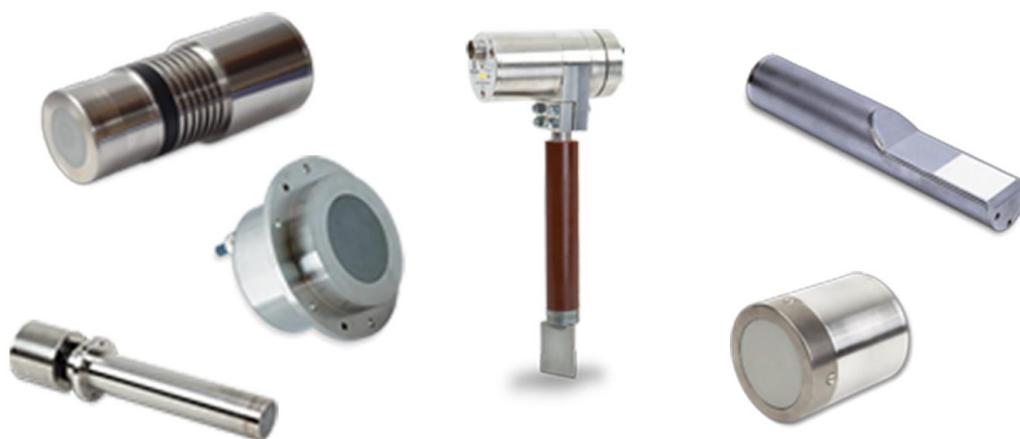
Os Sensores de Humidade por Micro-Ondas Hydronix utilizam filtros de processamento de sinal digital de alta velocidade e técnicas de medição avançadas. Deste modo, é obtido um sinal linear com a alteração da humidade no material cuja medição estiver a ser efetuada. É necessário instalar previamente o sensor num fluxo de material para que o sensor possa apresentar online os resultados da alteração da humidade no material.
