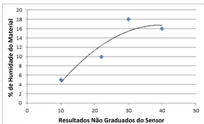
Imagem 21: Exemplo de uma Calibragem Quadrática Incorreta
