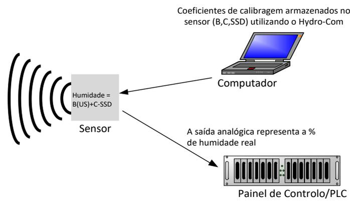
**Imagem 16: Calibragem no interior do Sensor**
