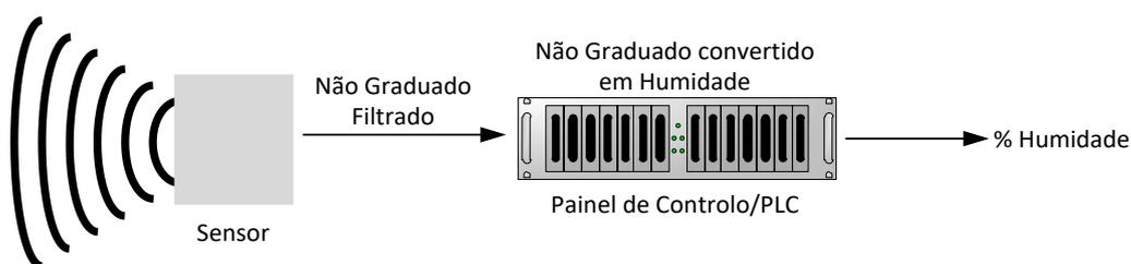
**Imagem 17: Calibragem no interior do Sistema de Controlo**
