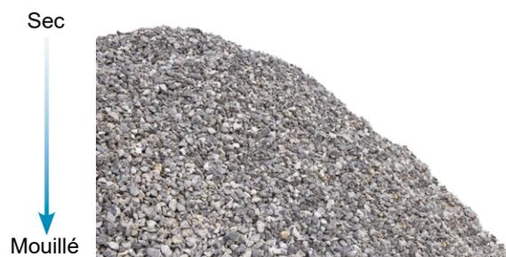
**Figure 1 : Évacuation naturelle de l'humidité à travers un tas d'agrégats**
