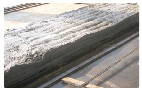
**Abbildung 2: Beispiel eines einfallenden Hohlkernbetons aufgrund falscher Konsistenz**
