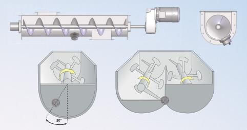
只要陶瓷面板上有持续的物料流,Hydro-Mix XT 就可以安装在许多不同的位置,这包括干燥、管道、传送和搅拌系统。
