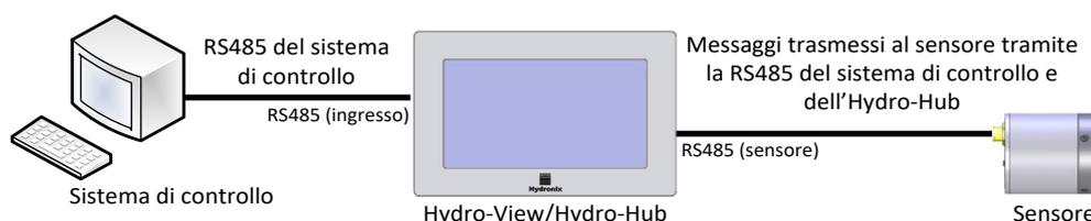
Figura 17: Marshalling dell'interfaccia RS485 da parte di Hydro-View / Hydro-Hub
