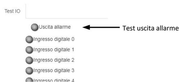
Figura 50: Test uscita Allarme
