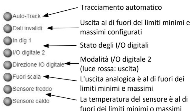
Figura 84: Stato corrente del sensore
