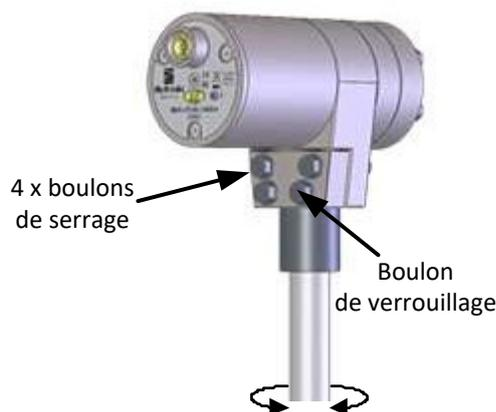
Figure 15 : réglage de l'angle de la tête de détection
