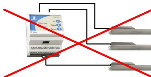
**Ilustración 23: Cableado RS485 incorrecto**
