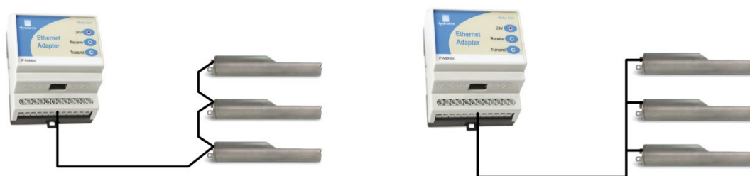
Рис. 22: Правильно выполненные кабельные соединения сети RS485
