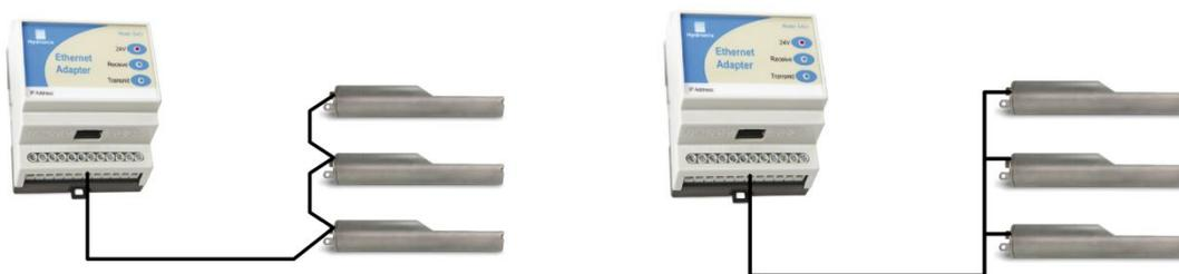
Figure 22 : réseau de câbles RS485 correct
