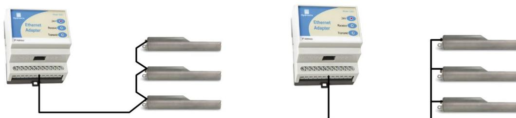
图 22: 正确的 RS485 电缆网络
