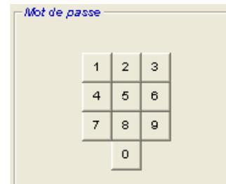
Il y a deux types de mot de passe. Les mots de passe du premier niveau permettent de mettre à jour le logiciel ; les mots de passe du deuxième niveau permettent de mettre à jour le logiciel et de modifier les facteurs de compensation de la température et les paramètres des étalonnages pour l'air et l'eau.
