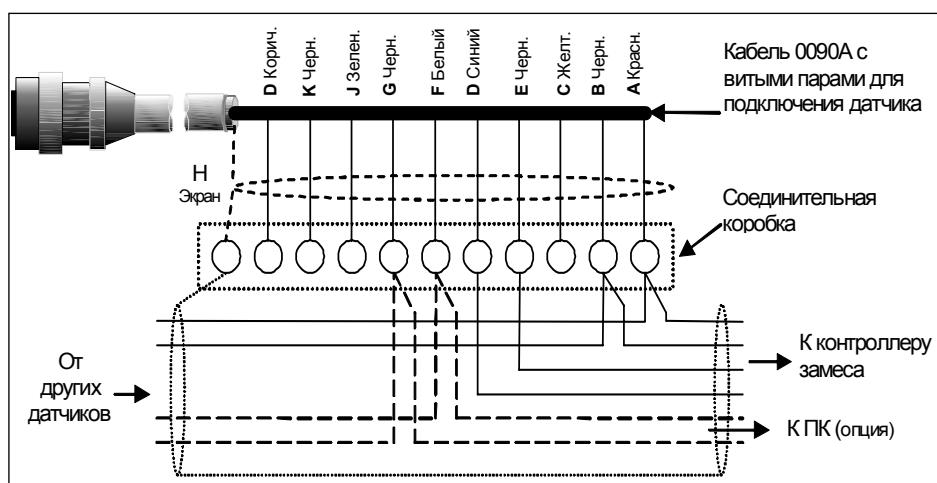
Рисунок 15. Подключение аналогового выхода.
