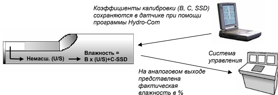
**Рисунок 24. Калибровка внутри датчика Hydro-Probe II**
