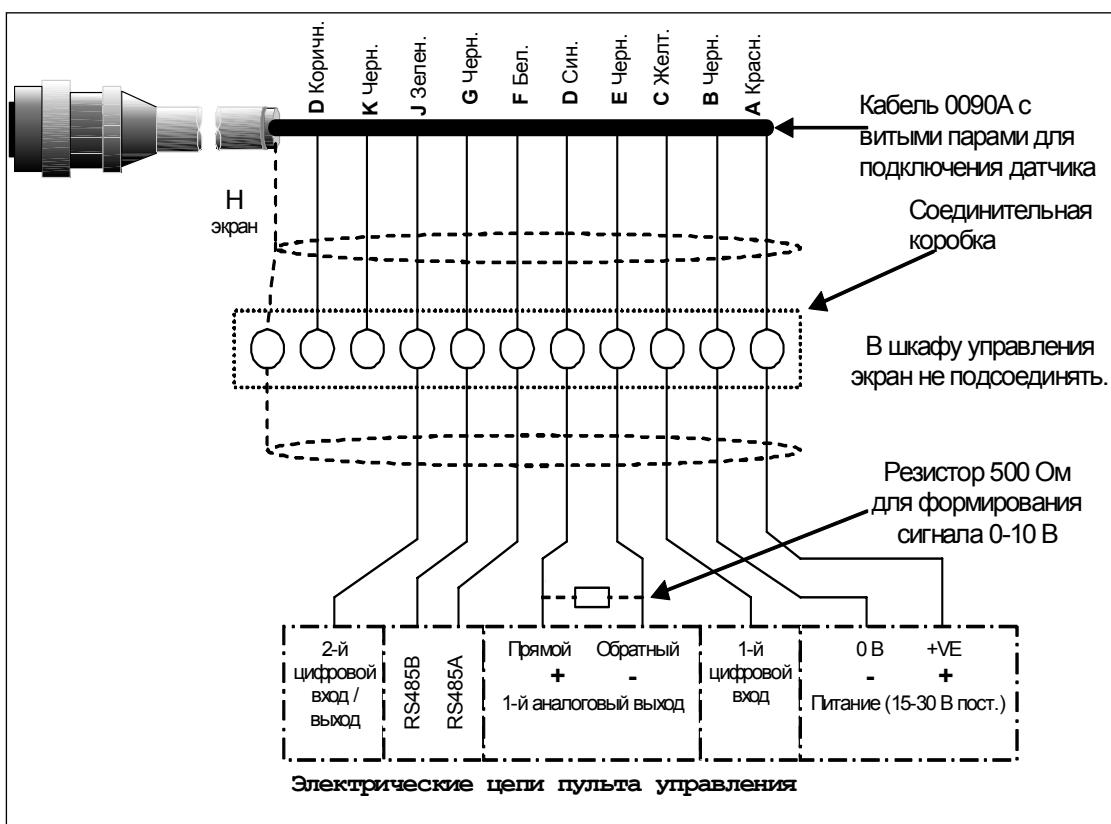
Рисунок 14. Разводка кабеля датчика
