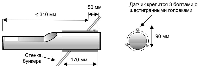
Рисунок 11. Стандартная установочная гильза (деталь № 0025)
