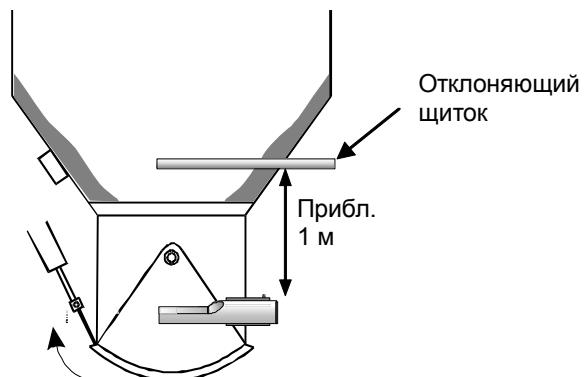
Рисунок 4. Установка защитного отклоняющего щитка
