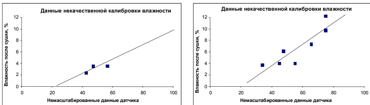
**Рисунок 27. Пример ненадлежащего выбора точек калибровки материала**
