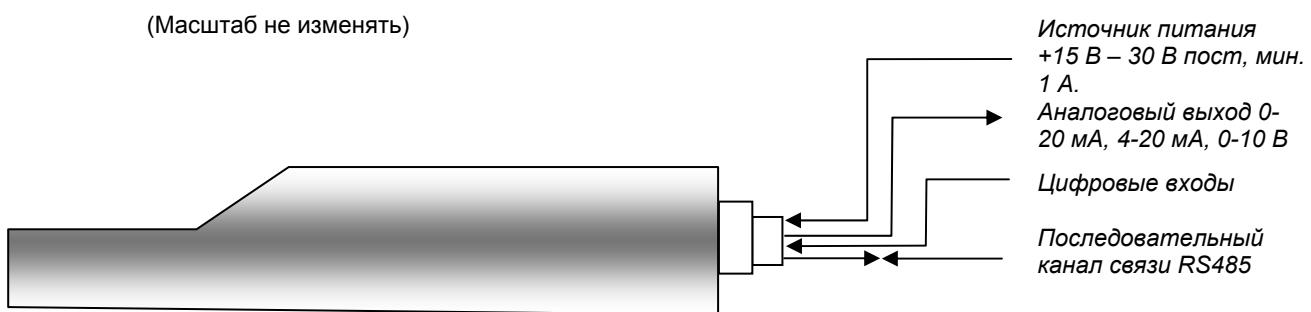
Рисунок 2. Подключение датчика (общее представление)
