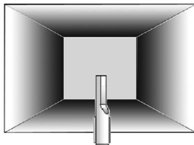
**Рисунок 5. Вид сверху на датчик Hydro-Probe II, установленный в бункере**
