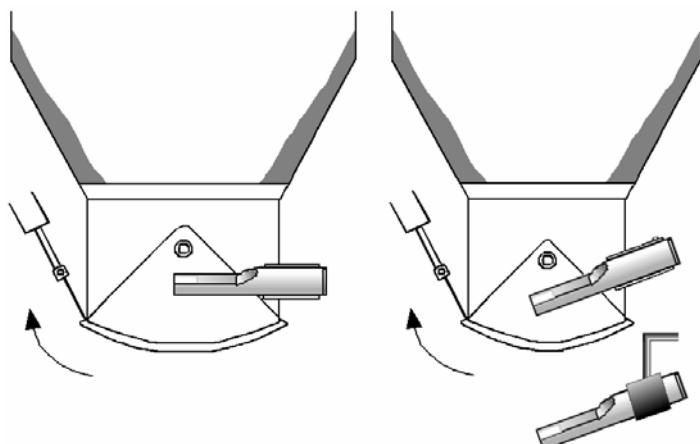
**Рисунок 6. Монтаж датчика Hydro-Probe II в горловине бункера**
