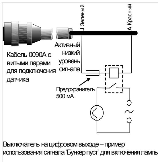
Рисунок 18. Активация цифрового выхода 2
