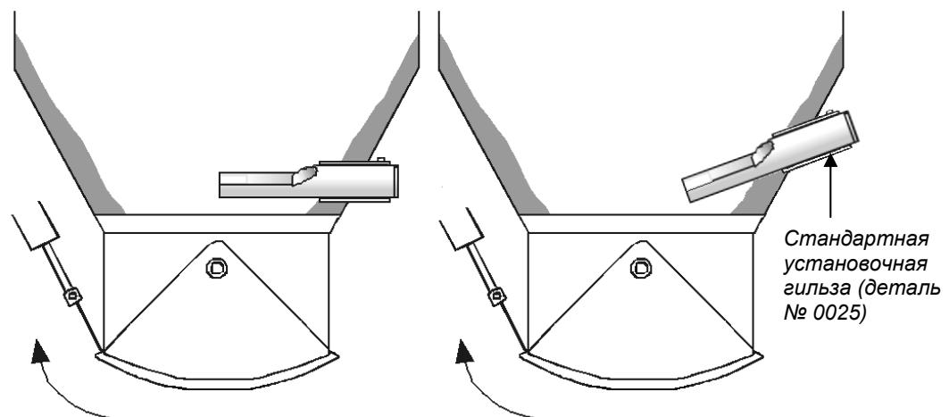
**Рисунок 7. Монтаж датчика Hydro-Probe II в стенке бункера**
