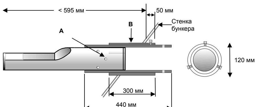
Рисунок 12. Удлиненная установочная гильза (деталь № 0026)
