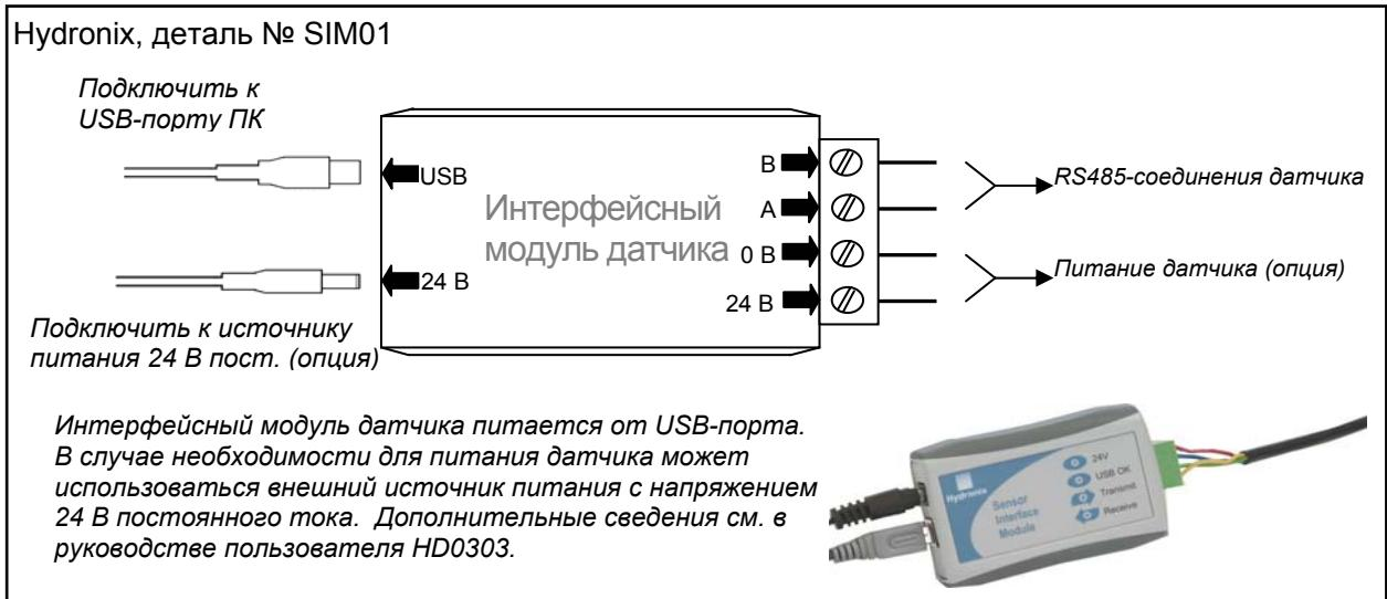
**Рисунок 22. Схема подключения преобразователя (SIM01) интерфейсов USB-RS485**
