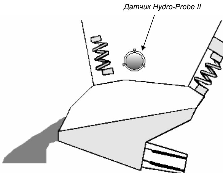
Рисунок 9. Монтаж датчика Hydro-Probe II в вибрационном питателе
