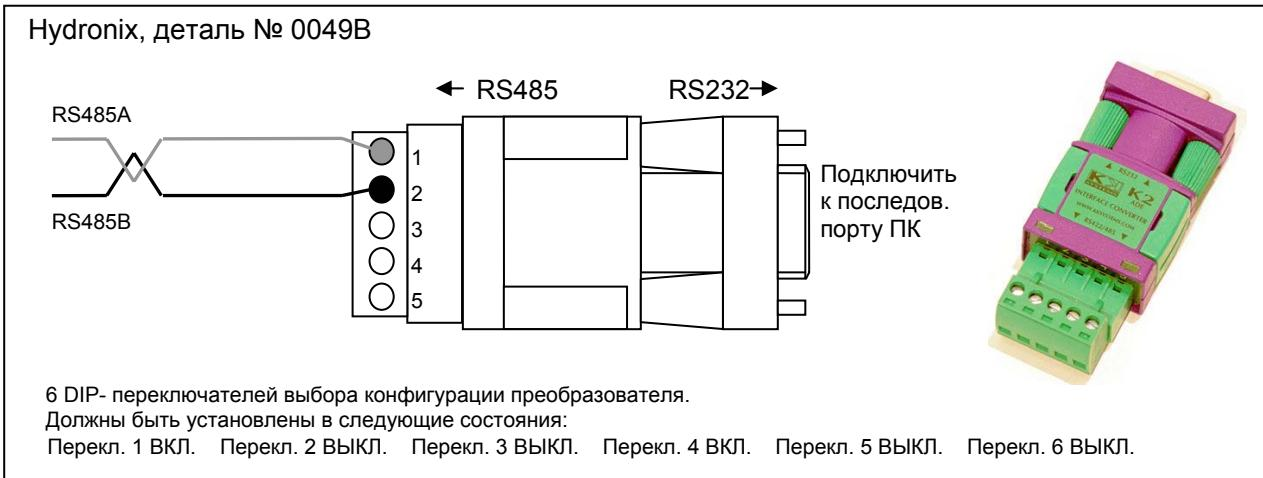
**Рисунок 20. Схема подключения преобразователя RS232/485 (1)**
